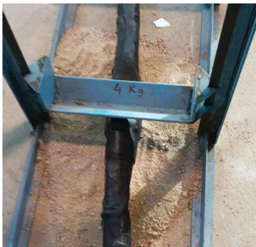
Figura 3.- Montaje impacto a temperatura ambiente.
