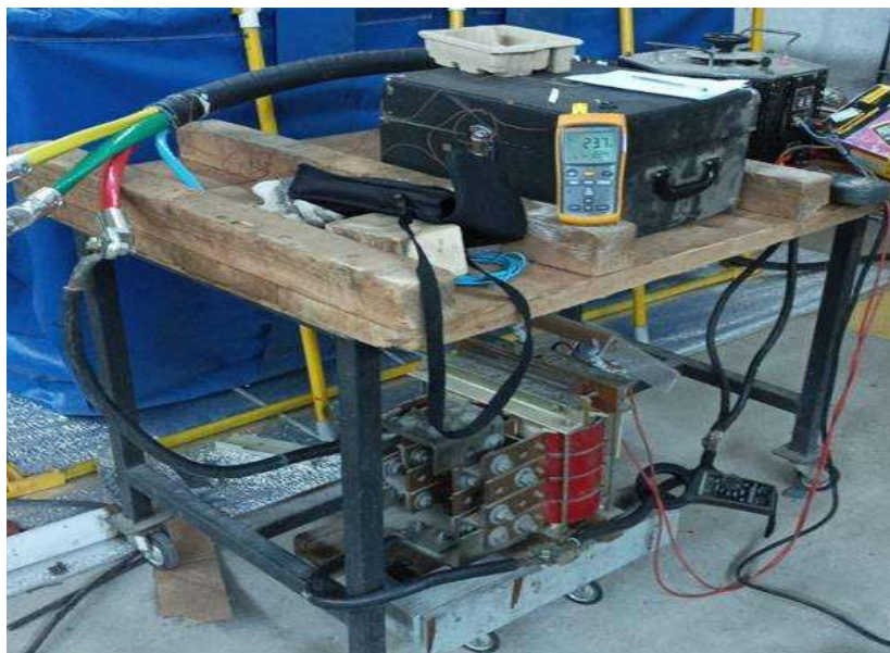
Figura 1.- Calibración del cable de muestra en función de la temperatura del conductor.
